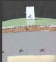
Isolation aus Polyurethan Schaum 10 mm zwischen 2 Polyester Schichten
