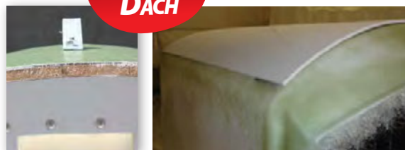
Isolierung aus Polyurethanschaum (10 mm) zwischen zwei Polyesterschichten
