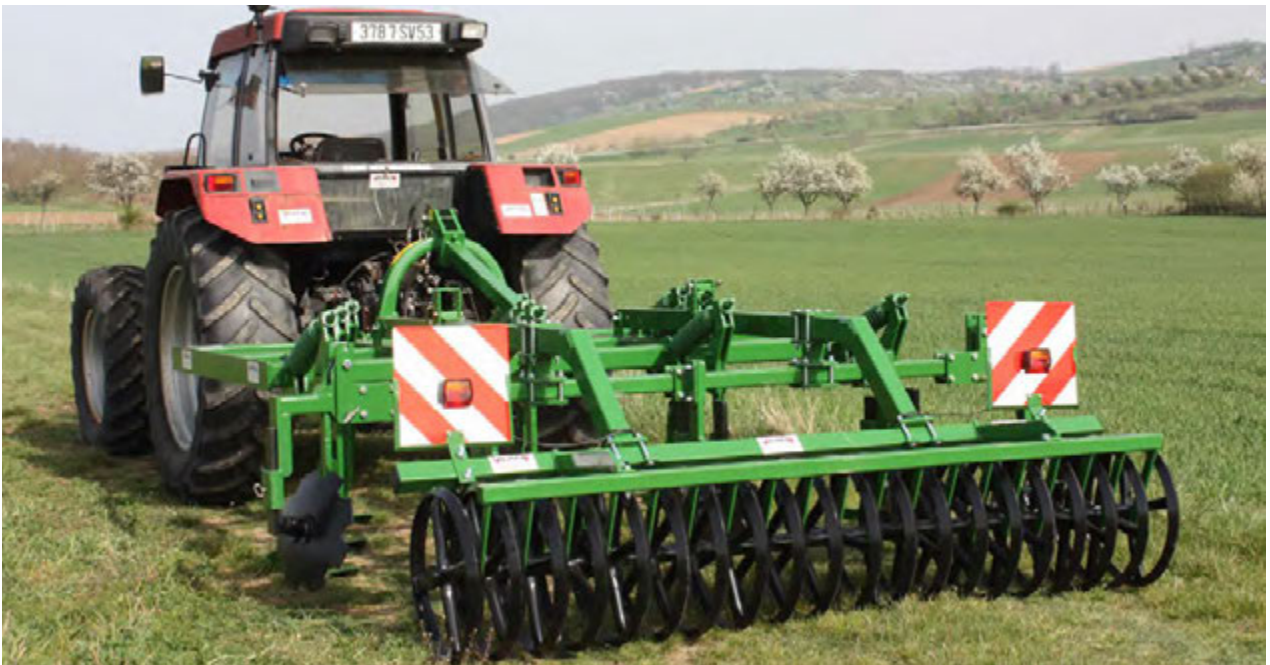
> Schar mit oberem Streichblech (Zinken 840 x 25 mm und Schar 300 mm)
