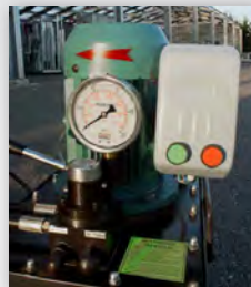
380 V-Motor mit Steuerkasten und Druckmanometer
