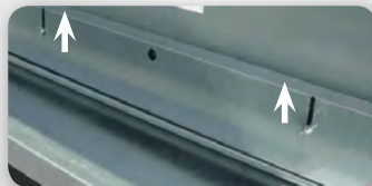
Anzuhebende Griffe zum Erhöhen der Futtermenge
