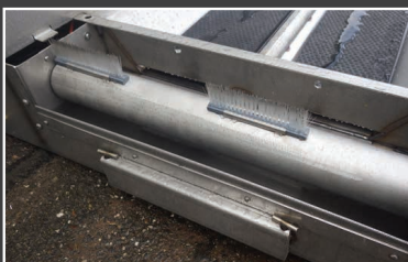
Sammelwanne mit Filter, Bürste und Trommelmotor
