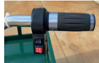
• Beschleunigungsgriff : > Rote Taste für die Vorwärts- und Rückwärtsfahrt, > Schwarze Taste zum Einstellen der Höchstgeschwindigkeit
