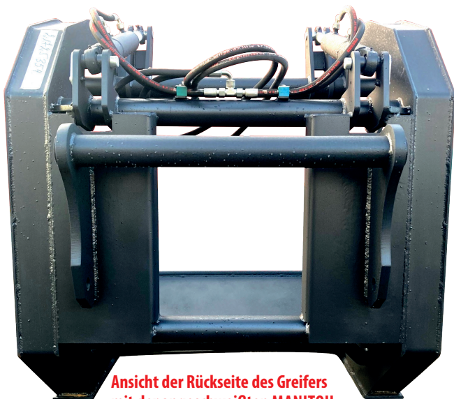
Ansicht der Rückseite des Greifers mit der angeschweißten EURO-Befestigung
