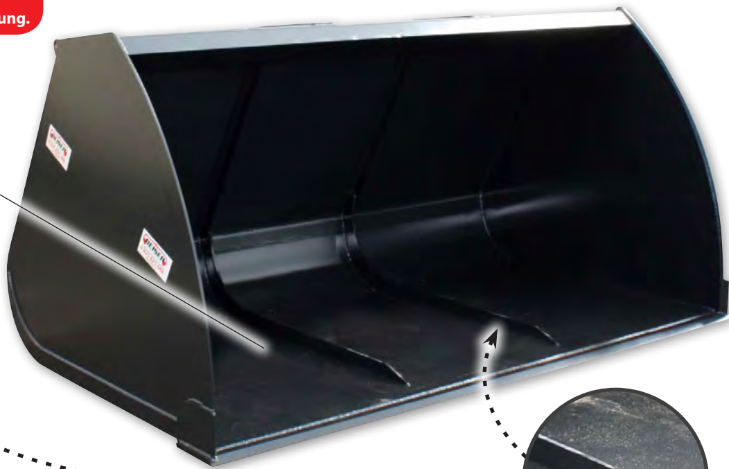
Schürfleiste aus Hardox Stahl 500 HB (150 x 20 mm)
