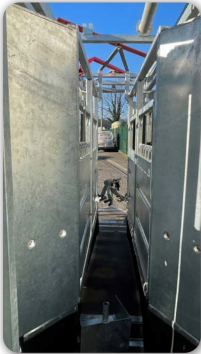
Reduzierung der Breite 800mm-400mm auf dem vorderen Teil des Ganges
