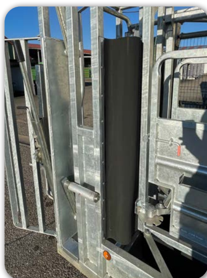
Schutz durch Gummibälle an der Vordertür. Vermeidet den Kopfdurchlass des Jungviehs
